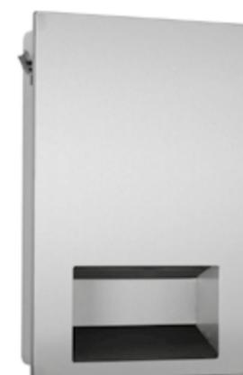
**M440-S** Sèche-mains à air pulsé 2600W pour une installation dans la cloison. Profondeur d'encastrement de 100mm ce qui permet l'installation dans des cavités étroites. Alimentation 220/240V Fréquence 50/60Hz.. Ce sèche-mains peut être installé en combinaison avec le distributeur d'essuie-mains E040S et/ou la poubelle P740S.
