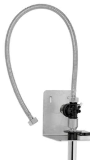
**R390** Robinet électronique pour installation derrière miroir. Détection de mouvement par cellule infrarouge, distance de détection réglable. Buse finition brillant. Alimentation par transformateur 9V sur secteur. Débit 6L/min avec possibilité de régler le débit d'eau à 1.89L/min.
