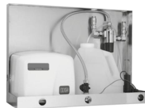
**T590** Module 'Savon-Eau-Air' pour installation derrière miroir. Distributeur de savon électronique avec container savon 5L, robinet électronique et sèche-mains automatique. Buses à finition brillant. Permet la centralisation à proximité immédiate du plan vasque, du lavage et du séchage des mains.
