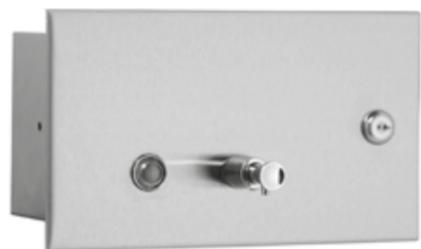
**S230-S** Distributeur de savon liquide à encastrer dans la cloison. Réservoir intérieur capacité 1200ml. Dimensions intérieures pour l'encastrement : 125x235x105mm. Acier inoxydable AISI 304. Garantie 5 ans.
